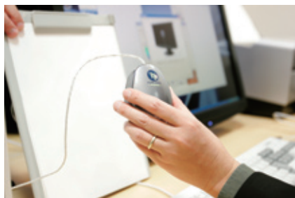
[写真1] 印刷用紙(今回は「PX マット紙(薄手)」を使用)から25cm離れた位置で測定器を構えて紙白(かみじろ:紙の地色のこと)を測る。紙白と同時に、モニタ周りの明るさも取り込めるのがポイントだ。
