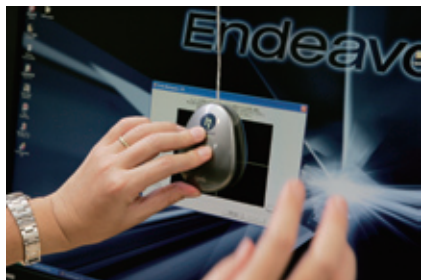
[写真2] 測定結果を基にモニタの調整を行う。モニタをやや上向きに傾け、測定器を取り付ける。センサー周囲の吸盤と重りで、ずり落ちることなく固定される。
