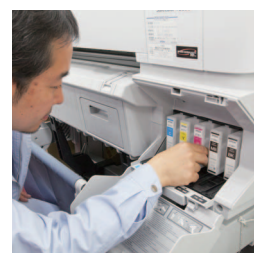
インクカートリッジの交換も、前面から簡単に可能。
