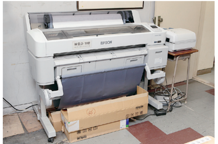
職員室に隣接している資料室に設置され職員は自由に使える。主要な操作はすべて前面から行えるので壁面へ寄せ、省スペースを実現。
