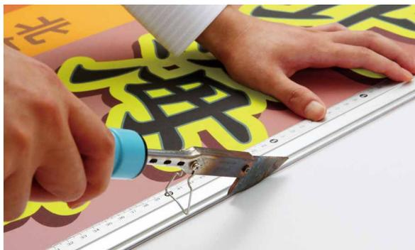
カットする。クロスメディアカッターを使えば溶融加工を施しながらヒートカットできるので切断面がほつれない。
