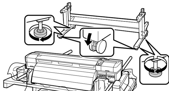
必ず固定した状態で本機をお使いください。キャスターが浮いていないことを確認してください。本機を移動するときは、固定具を逆方向に回して確実に上げ、キャスターのロックを外してください。
