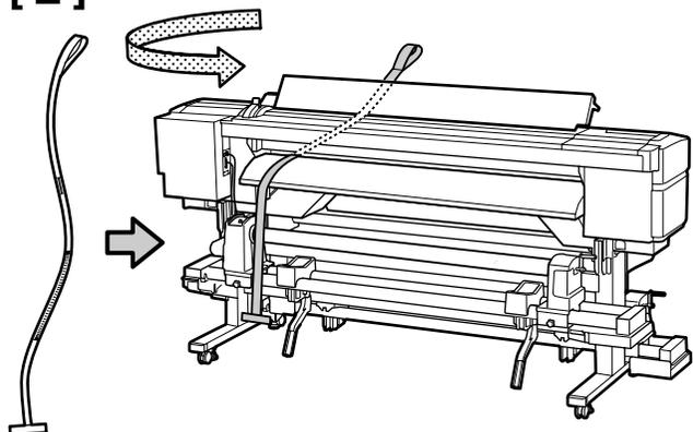
フィルムの輪になっている側を上にして、本機に挿入します。
