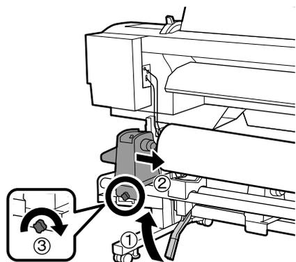
ロールの外径が 140mm 未満のメディアは、手で抱え上げてロールホルダーにセットしてください。
