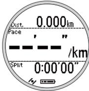
計測中に【C】を押すと、計測を一時停止します。
