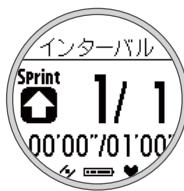
スプリントの時間（または距離）が経過すると、音/振動が鳴り、自動的にレストの計測が始まります。
