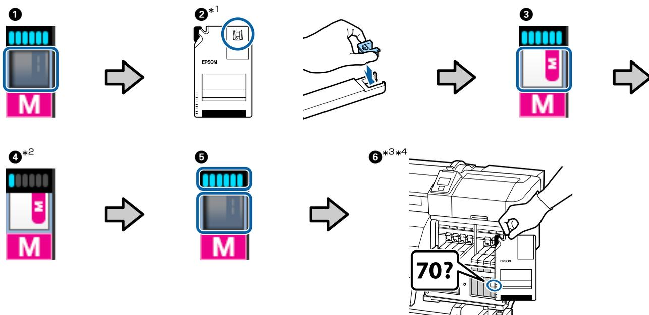
\*1 インクパックは補充時期（インクがインクタンクの底面から 70mm のときにインク 1 パックを補充）になるまで開封しないでください。
