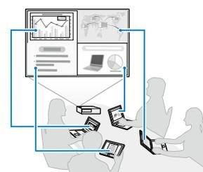
本機と同じネットワークに接続しているコンピューターやモバイルデバイスの映像を投写できます。
