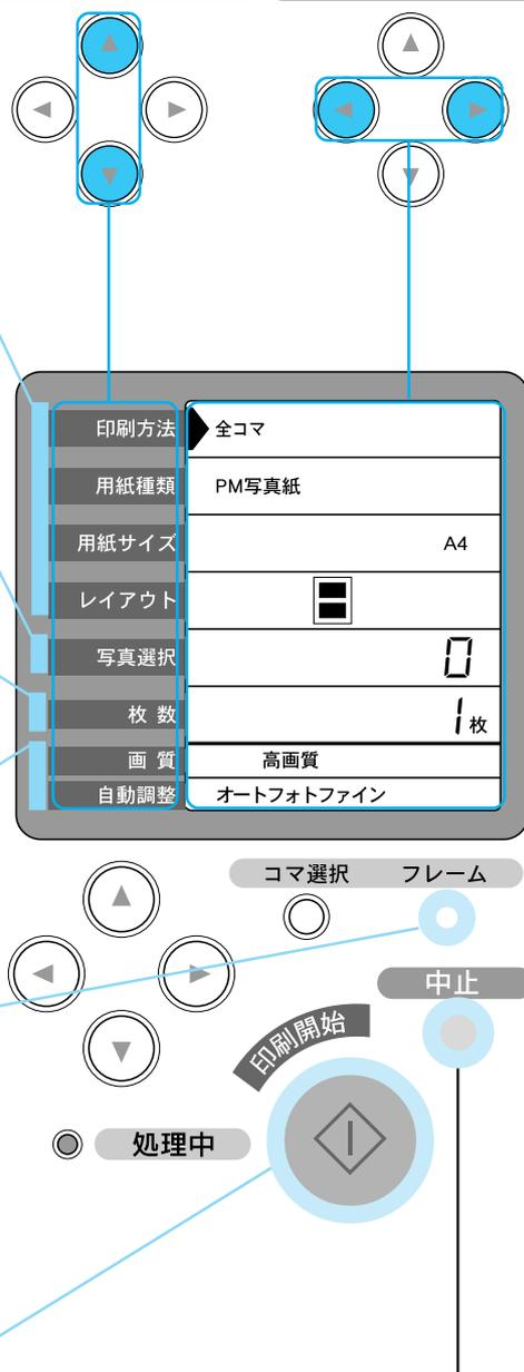
設定中に **中止** スイッチを押すと、すべての設定値を電源投入時の状態に戻します。
