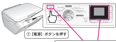
② 電源ランプと液晶ディスプレイが 消灯していることを確認
