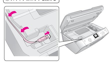
② USB ケーブルを本体のコネクタに差し込み、側面の 満に沿って取り付ける
