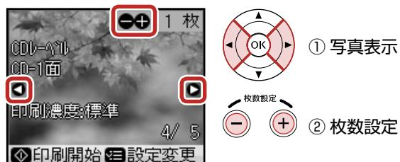
※ CD ケース -Index は、1 枚の用紙に写真を 24 個まで印刷できます（24 個未満のときは余白ができます）。【ズーム / 表示切替】ボタンを何回か押して 9 面表示にすると、選びやすくなります。
