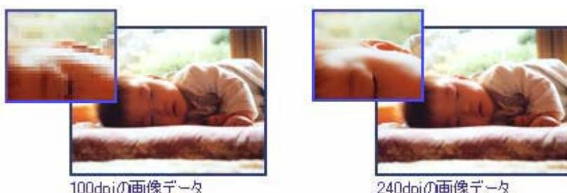
例えば 2880dpi 印刷とは、25.4mm (1 インチ) の長さ当りに 2880 個のインクの点を並べて打つことにより画像を構成していることを意味します。
