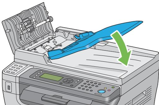
6 トップカバーを閉じ、原稿を自動原稿送り装置にセットしなおします。
