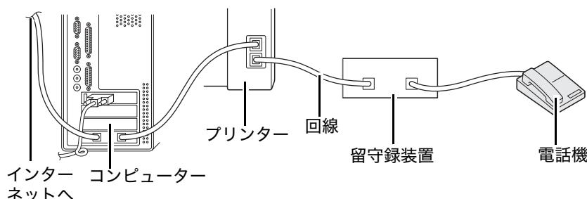
ファクスまたはダイヤルアップインターネット接続にコンピューターのモデムを使用する場合は、上の図のようにコンピューターのモデムを直接留守録装置のついたプリンター背面に接続してください。
