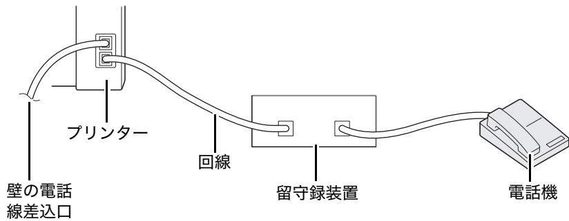
上の図のように留守録装置は直接プリンターの背面に接続できます。
