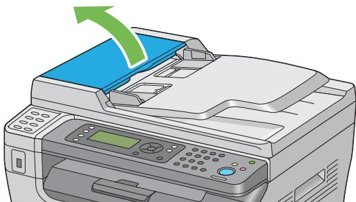
2 詰まった紙は、下図に示す矢印の方向に慎重に引き抜いて除去してください。
