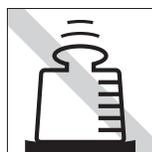
本機の上に重い物を載せたり、LCDユニットを強く押さえつけたりしないでください。LCDやバックライトが破損したり、表示異常となることがあります。
