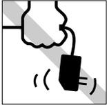
ACアダプタはコードを持って抜き差ししないでください。コードの断線や接触不良の原因となります。
