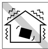
他の機械の振動が伝わる所など、振動しがちな場所には置かないでください。故障、誤動作の原因になります。
