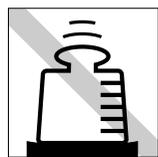
本製品の上に重い物を載せたり、カバーを強く押え付けしないでください。LCDやバックライトが破損したり、表示異常となることがあります。
