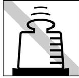
カバーを強く押さえないでください。カバーの中には、液晶ディスプレイ用の蛍光灯があります。部分的に強く力を加えると、この蛍光灯が破損することがあります。また、液晶ディスプレイのガラスが破損したり表示不良になることがあります。
