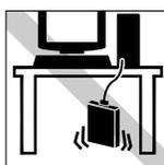
FDD本体をぶらさげた状態で使用しないでください。ケーブルの断線や接触不良の原因になります。
