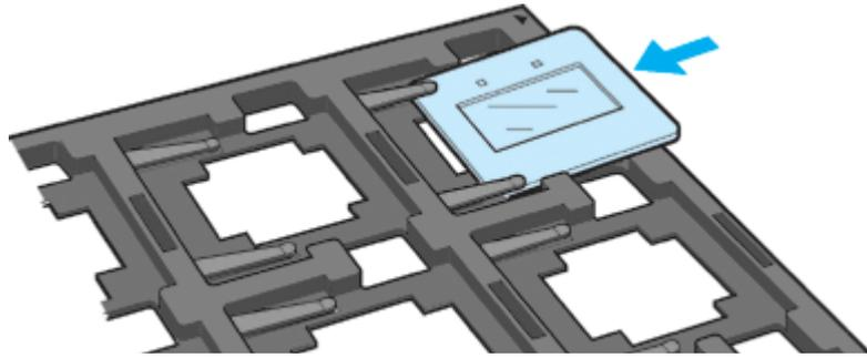
2. 透過原稿ユニットを開けます。フィルムのベース面が下になるように、フィルムホルダを原稿台にセットします。
