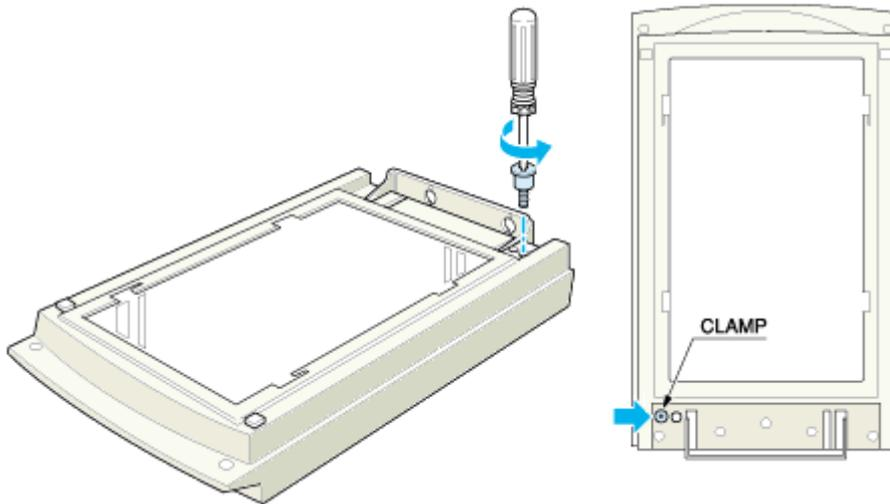
3. 取り外したネジを、図の位置の保管（STOCK）穴に取り付けます。
