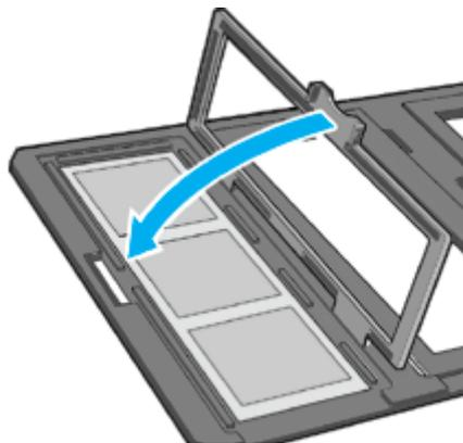
2. 透過原稿ユニットを開けます。フィルムのベース面が下になるように、フィルムホルダを原稿台にセットします。
