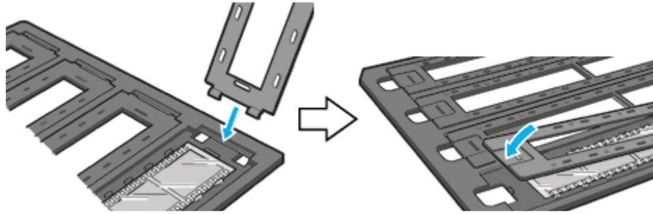
2. 透過原稿ユニットを開けます。フィルムのベース面が下になるように、フィルムホルダを原稿台にセットします。
