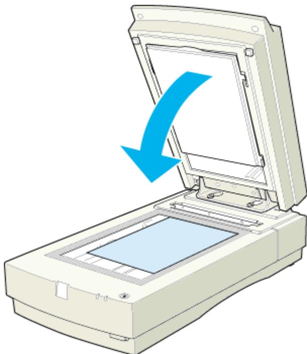
再び透過原稿を取り込む場合は、反射原稿マットを取り外してください。
