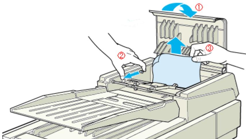
原稿を取り除いたら、ADF のカバーを閉じてスキャナをリセットします。
