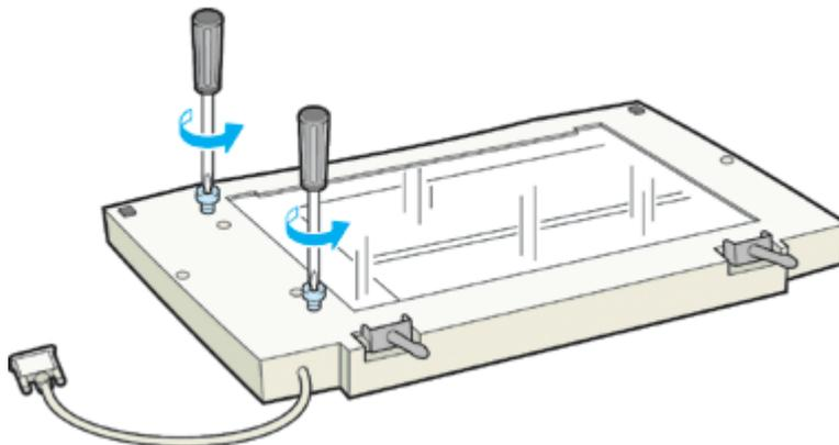
3. 取り外したネジを、図の位置の保管 (STOCK) 穴に取り付けます。
