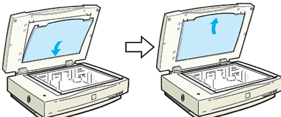
3. 原稿をセットし、透過原稿ユニットを閉じます。
