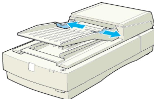
2. 原稿の取り込む面を上にして、左のエッジガイドを基準にして奥に突き当たるまで差し込みます。
