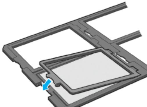
2. 透過原稿ユニットを開けます。フィルムのベース面が下になるように、フィルムホルダを原稿台上にセットします。
