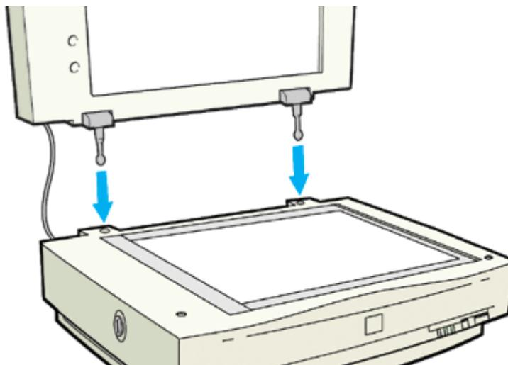
4. 透過原稿ユニットを閉じます。スキャナ背面のオプションコネクタに透過原稿ユニットのコネクタを取り付け、コネクタ両脇のネジで固定します。
