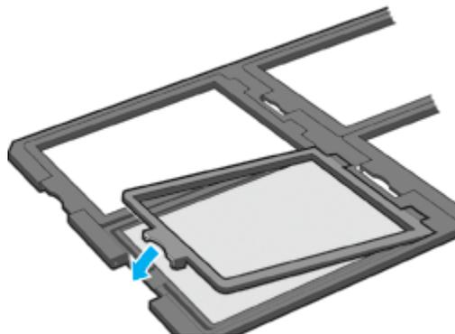
2. 透過原稿ユニットを開けます。フィルムのベース面が下になるように、フィルムホルダを原稿台にセットします。
