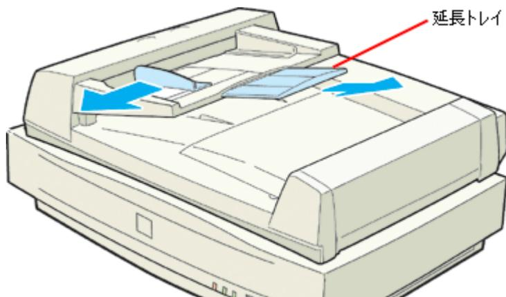
**2. 原稿の取り込む面を上にして、ADF の目盛りに合わせて奥に突き当たるまで差し込みます。**
