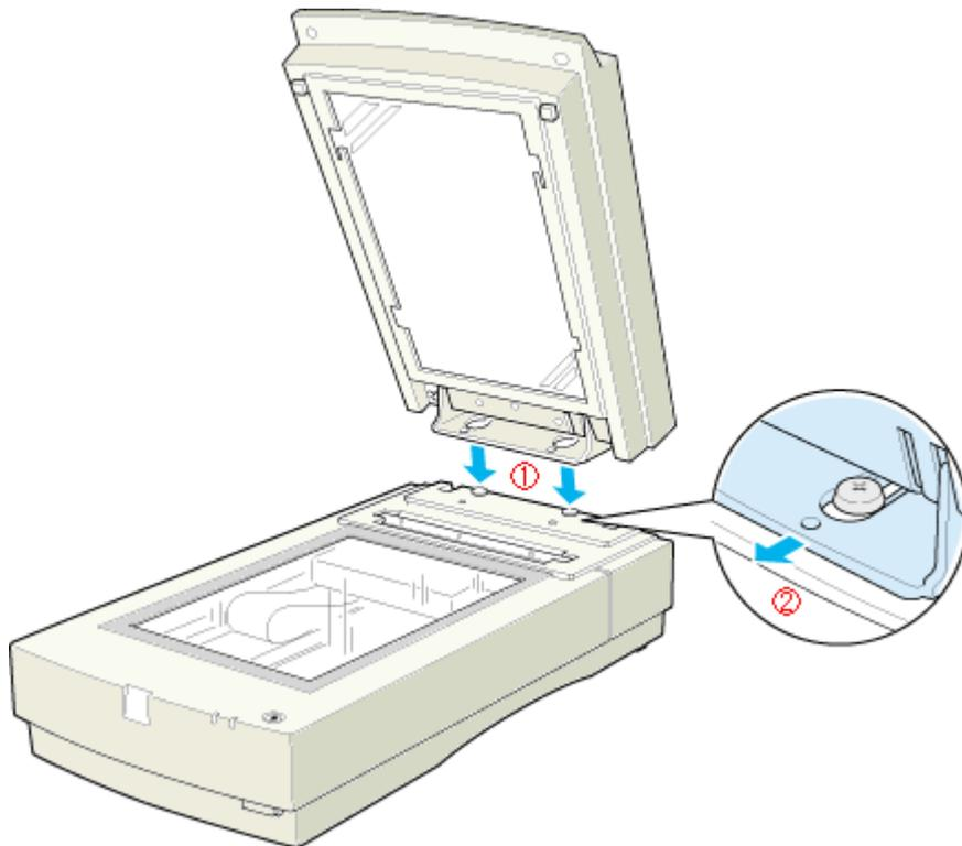
3. 透過原稿ユニットに付属のネジで、透過原稿ユニットを固定します。
