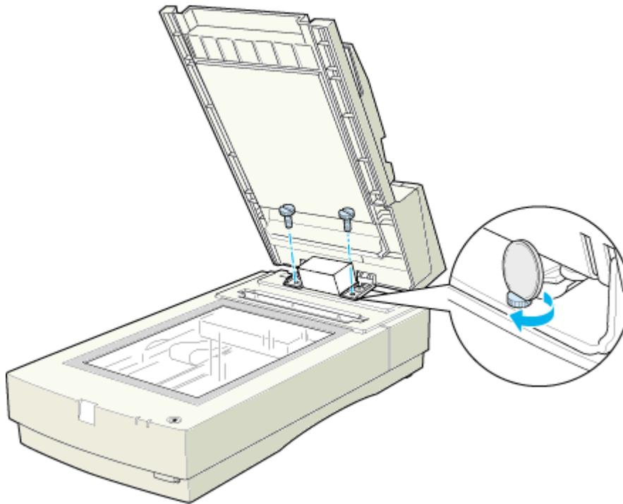
**4. ADF の取り付け金具から保護パットを取り外します。**
