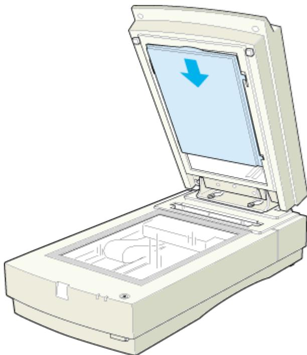
2. 原稿をセットし、透過原稿ユニットを閉じます。
