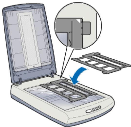
2. フィルムホルダに、フィルムのベース面（像が正しく見える面）を下に向けてセットします。
