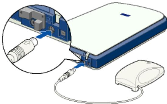
3. 電源プラグをコンセントに差し込み、スキャナの電源をオンにします。
