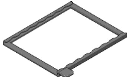
1. フィルムホルダに、フィルムのベース面（像が正しく見える面）を下に向けてセットします。
