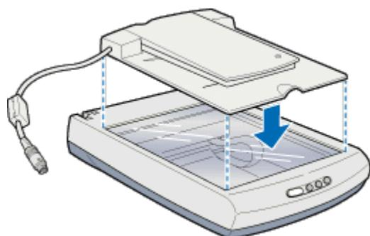
4. 透過原稿ユニットの接続ケーブルを、スキャナに接続します。
