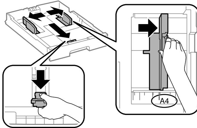
3. 印刷する面を下にしてセットして、手前の用紙ガイドを用紙に合わせてみます。
