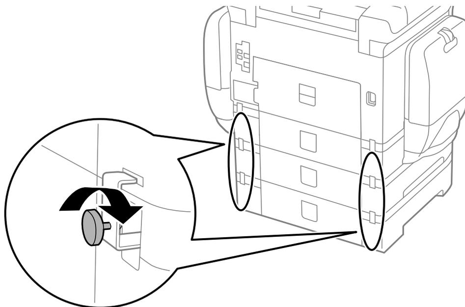
10. 増設カセットユニットにセットする用紙サイズ用の用紙サイズラベルをホルダーに差し込みます。
