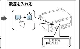
上の画面が表示されないときは電源を切 り、保護材の取り忘れがないことを確認し てから電源を入れ直してください。
