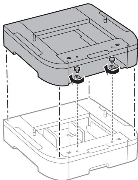
8. プリンターを、増設カセットユニットの四隅と合わせながらゆっくり下ろして置き、ドライバーを使ってネジで固定します。
