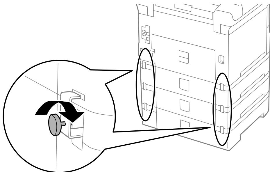
10. 増設カセットユニットにセットする用紙サイズの用紙サイズラベルをホルダーに差し込みます。
