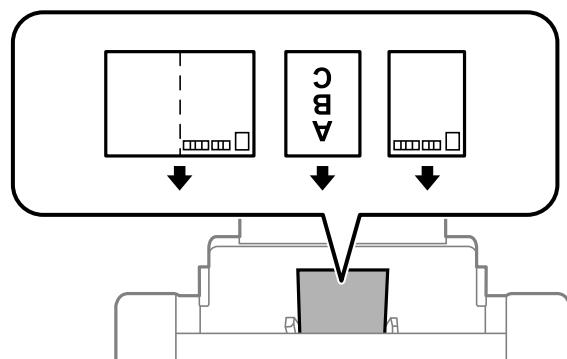
用紙カセットにセットするときは、印刷する面を下にしてセットし、用紙ガイドをハガキに合わせてください。
