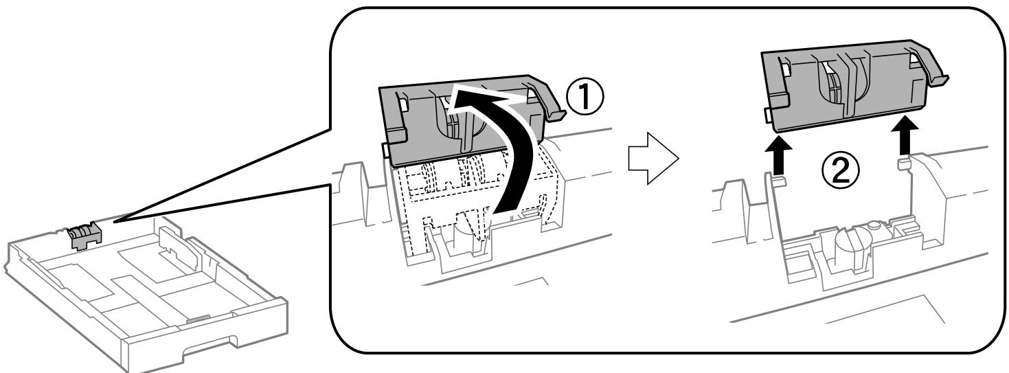
9. 新しい給紙ローラーを用紙カセットに取り付けます。
