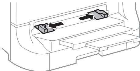
3. 印刷する面を下にして、プリンターが自動で用紙を少し引き込むまで用紙を差し込みます。
