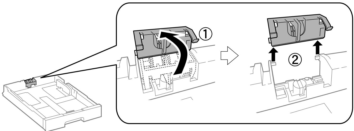
10. 新しい給紙ローラーを用紙カセットに取り付けます。
