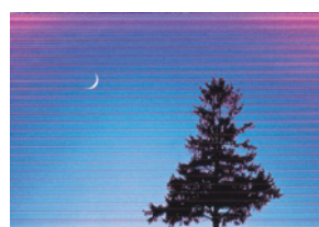
全体や部分的にスジが入る
